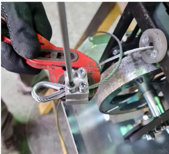
7) Montar de nuevo la pinza, siguiendo el revés del paso 1. Apretar los tornillos con un par 6 Nm
