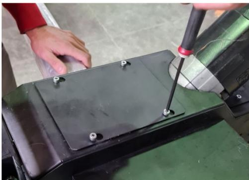
8) Montar de nuevo la cubierta con los 4 tornillos. Para enrollar el cable, conectar de nuevo electricidad y aire
