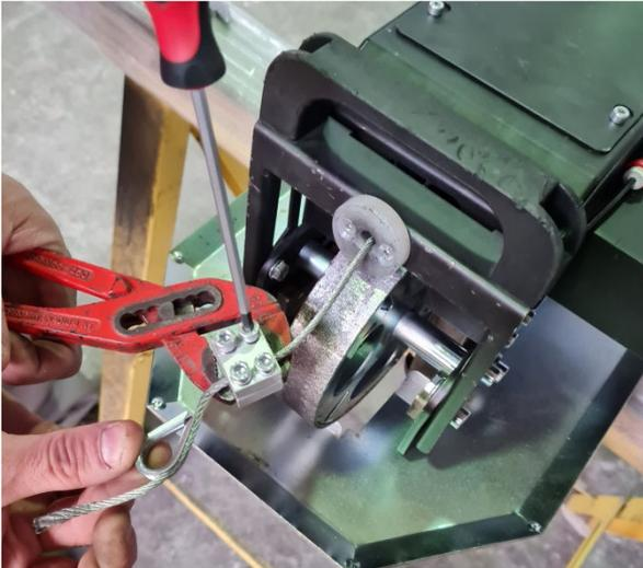
1) Aflojar los tornillos de la pinza sin sacarlos y enfilear el cable de acero. Mantener a mano la pinza
