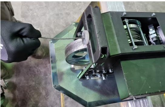
3) Desenrollar todo el cable y llevar a vista el tornillo que fija el cable
