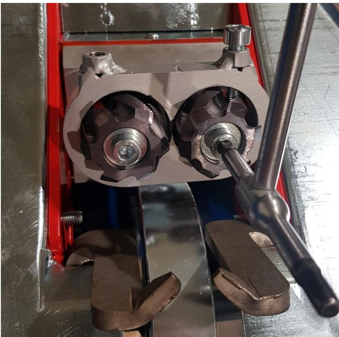
6) Primero aflojar ambos tornillos y luego desatornillar completamente.
