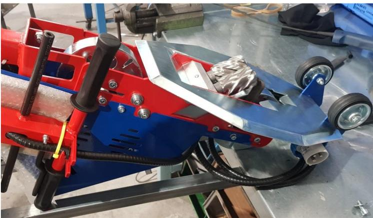
1) Desconectar enchufe y posicionar la PULIDORA volteada sobre una mesa.
