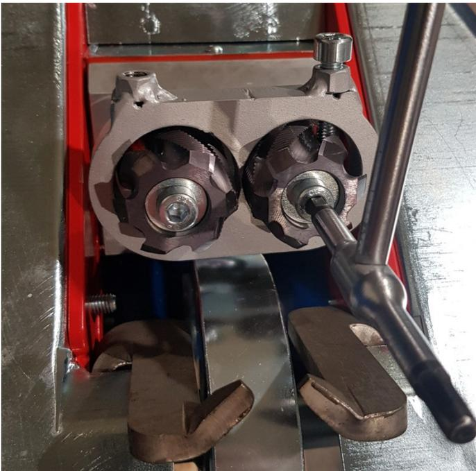
9) Primero se enfilan y luego se aprietan los tornillos que sujetan las fresas, con par de apriete de 28 Nm
