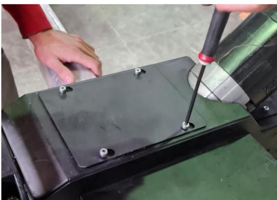
8) Vuelva a montar la tapa apretando los 4 tornillos cautivos. Para rebobinar el cable, conecte el sistema neumático y active la palanca
