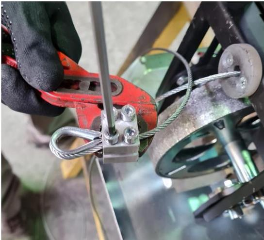
7) Vuelva a montar la abrazadera y el guardacabos que quitó al principio, apriete los 4 tornillos de la abrazadera (par de apriete = 6 Nm)
