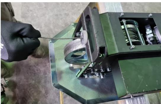
3) Desenrolle todo el cable y revele el tornillo que sujeta el cable
