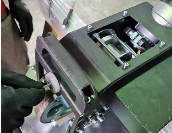
5) Inserte el cable nuevo en la guía del cable
