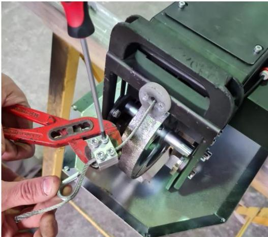
1) Afloje los tornillos del terminal sin quitarlos, extraiga el cable de acero. Recoge la abrazadera y el dedal
