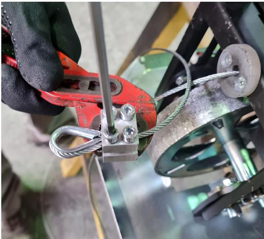
7) Rimontare il morsetto e la redancia smontati al inizio, stringere le 4 viti del morsetto (coppia di serraggio = 6 Nm)
