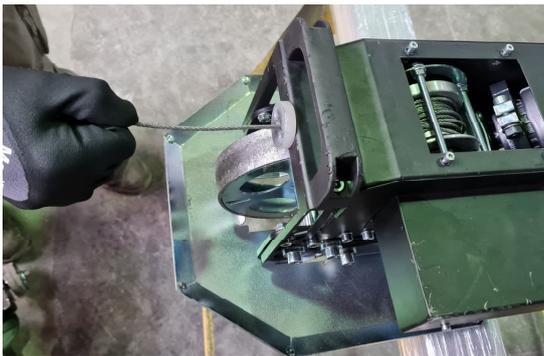
3) Srotolare tutto il cavo e portare a vista la vite che fissa il cavo
