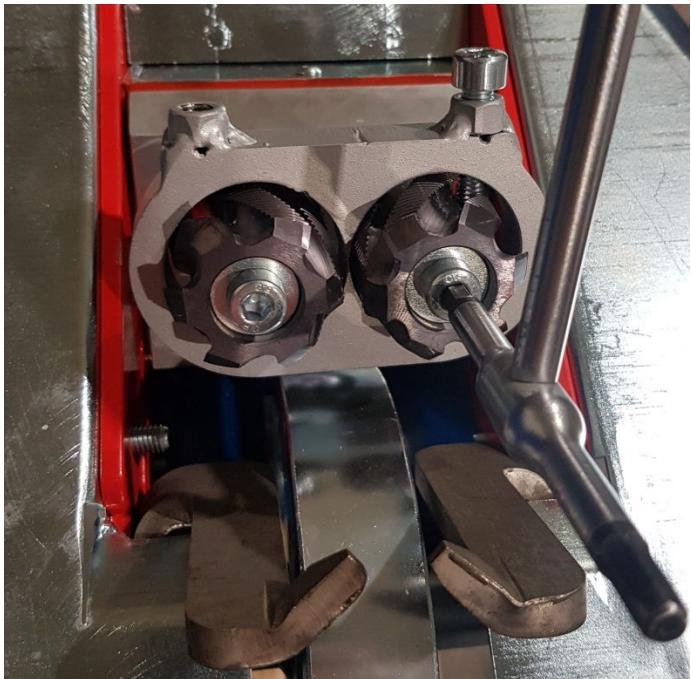
8) Prima si uniscono, poi si stringono le viti che tengono le fresa con una coppia di serraggio di 28 Nm
