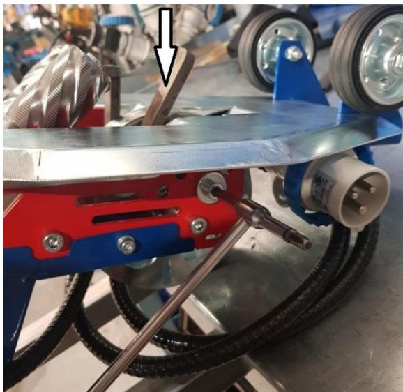
3) Allentare la seconda vite che tiene l'innesto e inclinarlo per consentire la rimozione delle fresa (ripetere l'operazione per entrambi gli innesti).
